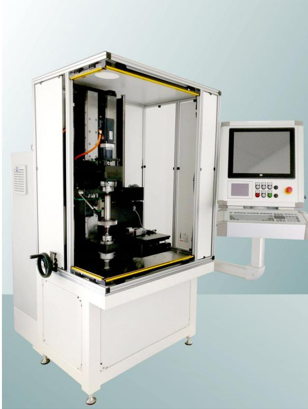
Die dabei gewonnenen Messergebnisse sind weitgehend vergleichbar mit denen taktiler Prüfeinrichtungen. Anders als bei den bisherigen Prüfmethoden lassen sich vergleichsweise schnell alle Zähne eines Prüflings messen und zur Bewertung heranziehen. Sollen nur wenige Prüfmerkmale (wie z.B. Teilungsfehler oder Rundlauf) bewertet werden, lassen sich Prüfzeiten deutlich unter einer Minute erreichen. Somit ist diese Prüfmethode auch für den Einsatz zur 100%-Kontrolle in Fertigungsumgebung nutzbar.
