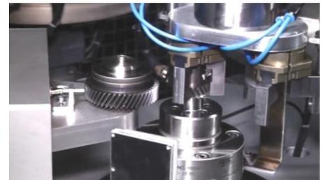
Die Prüfanlagen können, angepasst an die bestehenden Verhältnisse, mit unterschiedlichen Transportsystemen (Stau- und Palettenbänder) ausgerüstet werden. Die anlagen-interne Handhabung erfolgt über Roboter. Falls erforderlich, kann eine automatische Kalibrierung vorgesehen werden.
