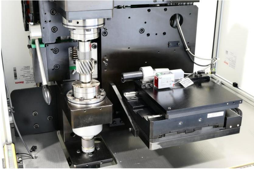
Die selbststehende Prüfanlage mit manueller Beladung und Entnahme prüft die Laufverzahnung ähnlich einer taktilen Messmaschine.
