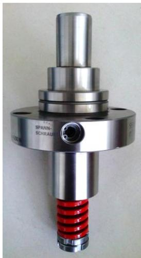
Eine Erfassung der relativen und der absoluten Kenngrößen (Achsabstand und MDK) ist mit hoher Genauigkeit möglich. Die Zentrierung ist optimal, Durchmesser- und Formabweichungen werden in Größenordnung der Dornexpansion ausgeglichen und das Werkstück kann über den Dorn angetrieben werden. Hinsichtlich der Aufnahme­genauigkeit lassen sich Spannreproduzierbarkeiten und Rundläufe bis unter  $3\ \mu\text{m}$  realisieren.
