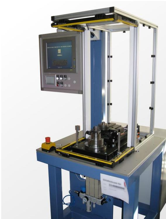
Der Prüfslitten besitzt einen elektrischen Servoantrieb, um so die im Prüfablauf geforderten Bewegungen automatisch durchführen zu können. Über ein, an diesem Schlitten angebrachtes Messsystem wird die Achsabstandsänderung zwischen beiden Werkstückachsen während der Zweiflankenwälzprüfung erfasst.
