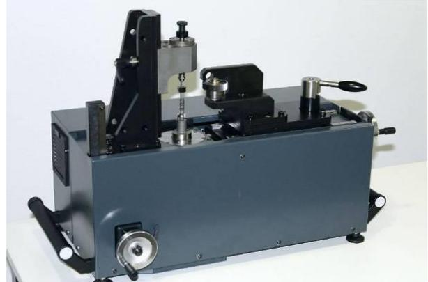
Abhängig von der Teilegeometrie können die Prüflinge entweder zwischen Spitzen oder auf (expandierenden) Dornen aufgenommen werden. Das Prüfgerät ist mit standardisierten Flanschen ausgerüstet, um einer große Zahl unterschiedlicher Spannmittel unterstützen zu können.
