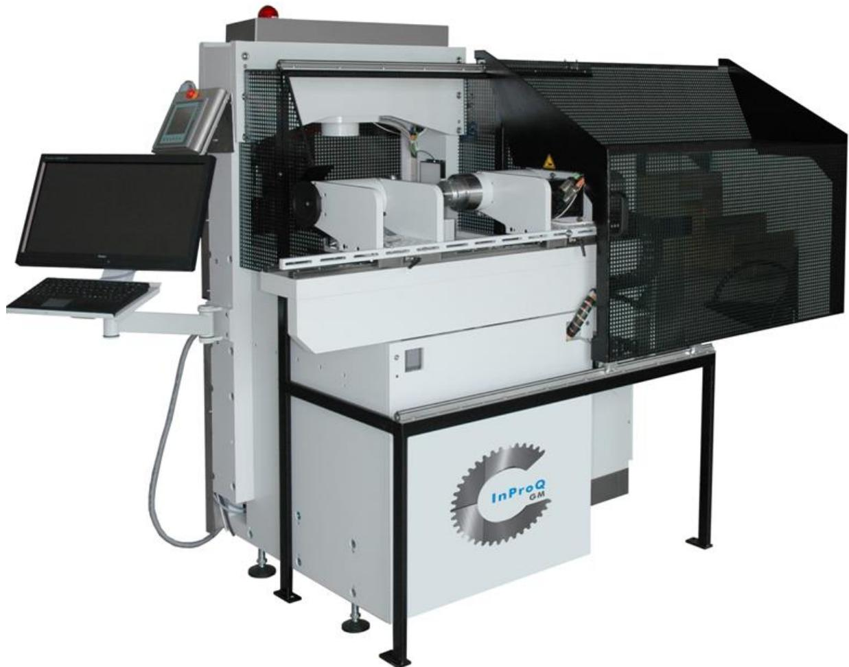
Der variabler Prüfstand für den Laborbereich ist in der Lage, Schneckenwellen und -räder, Stirnräder und in einer Ausbaustufe auch Kegelräder prüfen zu können. Das Gerät kann die Werkstücke mittels Zweiflankenwälzprüfung, Einflankenwälzprüfung und hinsichtlich der Geräusentwicklung prüfen.
