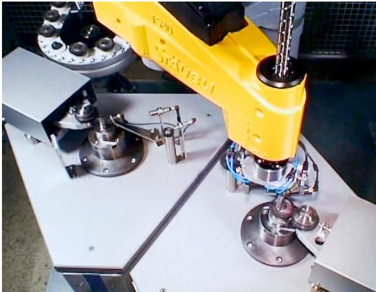
Derartige Prüfeinrichtungen sind in der Lage, jegliche Verzahnungsgeometrie mittels der oben beschriebenen Prüfverfahren (Zweiflankenwälzprüfung, Einflankenwälzprüfung und Geräuschprüfung) zu bewerten. Dabei sind Zykluszeiten (Boden-Boden) ab 15 Sekunden realisierbar.
